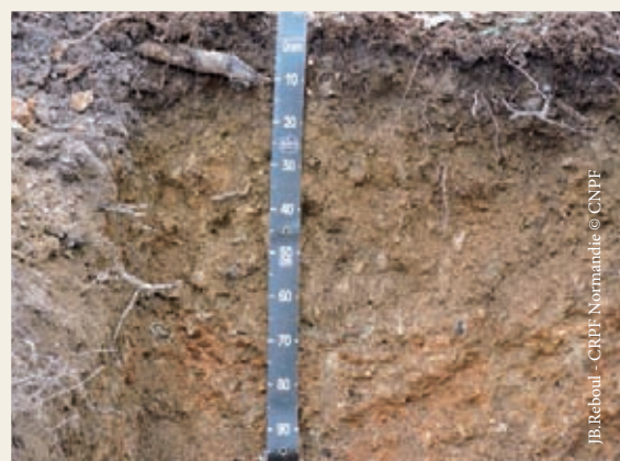
Sur ces limons sur argiles à silex moyennement chargés en silex (entre 30 % et 40 %), la tarière est bloquée dès la surface. Malgré la forte charge en silex et l'argile, on retrouve des racines fines à 90 cm. La réserve en eau n'est donc pas aussi faible que ce qu'indique la tarière.
